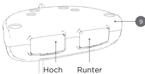
Zur Höhenverstellung die Tasten **+** und **-** der Bedieneinheit gedrückt halten. Beim Loslassen stoppt die Bewegung sofort. Im Gefahrenfall daher lediglich die Bedieneinheit loslassen (Totmannschaltung).
