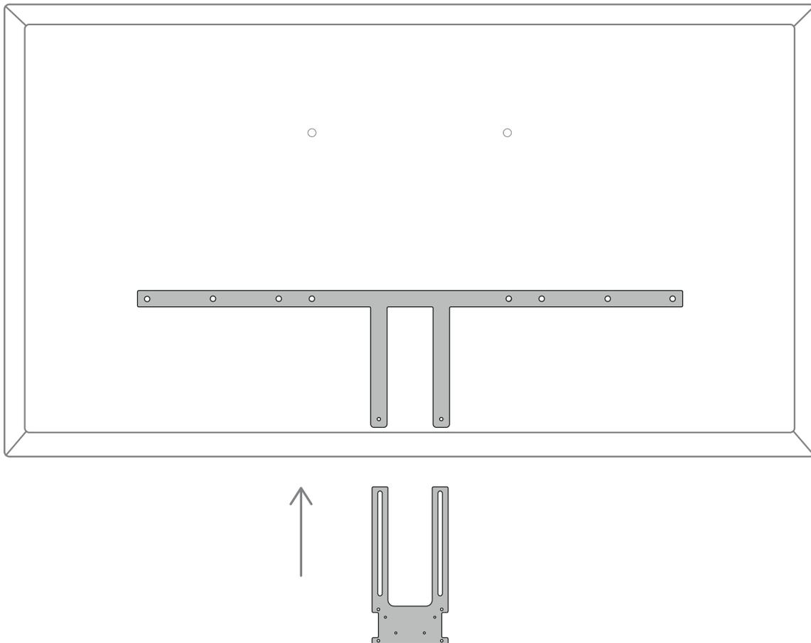
Schieben sie die untere Schiene in die obere Schiene ein und verschrauben sie beide miteinander.
