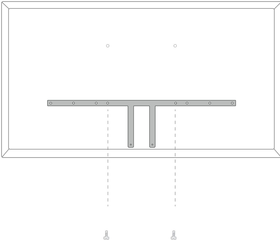
Verschrauben sie die obere Schiene mit dem Bildschirm.
