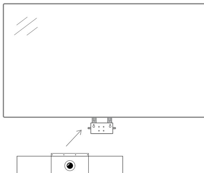
Setzen Sie die Poly Studio Konferenzkamera von vorn ein und verschrauben Sie diese wieder mit der Montageplatte.
