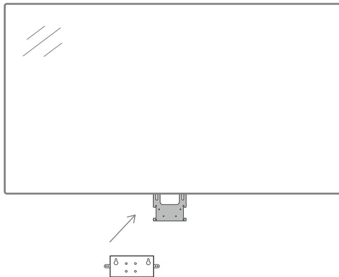
Schrauben Sie die Montageplatte an den Poly Display-Adapter, nutzen Sie das innere Lochbild.
