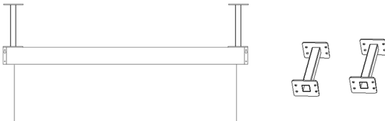
Die celexon Deckenabstandshalter sind ideal geeignet für die Installation von celexon Professional Plus Anbau-Leinwänden an der Decke.
