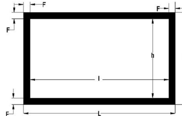
$F = 65\text{mm} (l \leq 240\text{cm}) / 87\text{mm} (l > 240\text{cm})$
