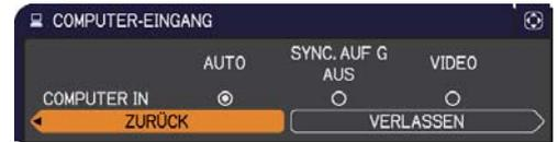
2. Stellen Sie für den Anschluss **AUTO** ein, um über **COMPUTER IN** Komponentensignale einzuspeisen. Nutzen Sie dann die Tasten **▲/▼/◀/▶**, um **VERLASSEN** zu markieren, und drücken Sie die Taste **▶**, um die Einstellung abzuschließen.
