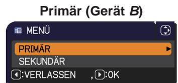
2. Nutzen Sie die Tasten ▲/▼/◀/▶ auf der Fernbedienung oder am Bedienfeld des Primärgeräts (Gerät **B**), um PERF. ANPASSG. im EINF.MENÜ oder im Punkt SETUP des Menüs FORTGESCHRITT auszuwählen. ([Benutzerhandbuch](#) → *EINF. MENÜ* oder *Menü SETUP*)
