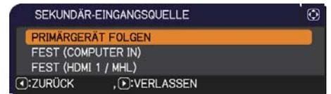
4. Nutzen Sie die Tasten ▲/▼, um die Option PRIMÄRGERÄT FOLGEN zu markieren, und drücken Sie die Taste ►, um die Einstellung abzuschließen. (📖23)
