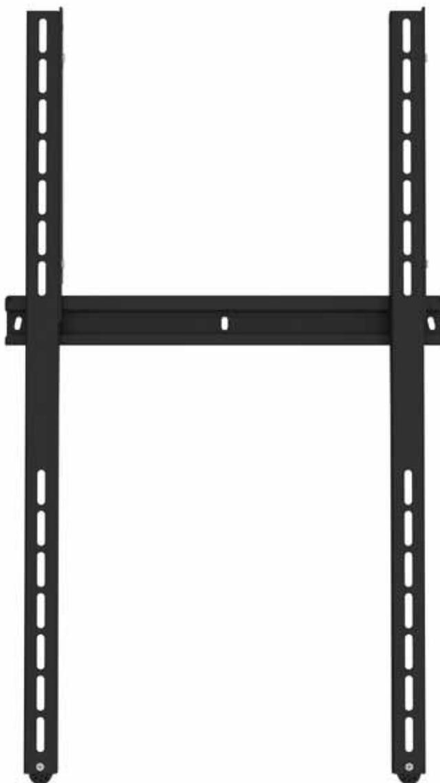
Ein leicht montierbares, universales Wandstativ zur vertikalen Aufhängung von Bildschirmen bis zu 55 Zoll. Das Lochbild passt genau über eine Wandschiene. Zum Schutz vor Personenschäden und Diebstahl kann es mit Splint- oder Hängeschloss versehen werden. Für Lochbilder von VESA 200x200 mm bis 800x400 mm.
