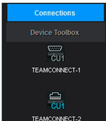
Die **Connections**-Liste wird automatisch generiert und zeigt alle im Netzwerk oder Subnetzwerk vorhandenen SL TeamConnect CU1-Geräte. Auf dem Icon jeder in der **Connections**-Liste vorhandenen SL TeamConnect CU1 wird die Art des Anschlusses über ein Symbol des jeweiligen Steckers (USB, RS-232 oder Ethernet) angezeigt. Unter dem Icon wird der Gerätenamen der SL TeamConnect CU1 angezeigt.
