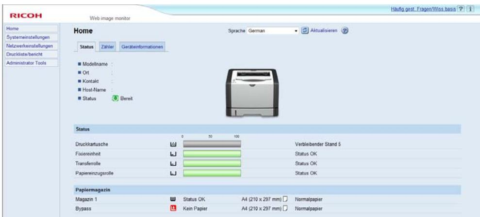
Sie können den Status des Geräts überprüfen und dessen Einstellungen konfigurieren, indem Sie über Web Image Monitor direkt auf das Gerät zugreifen.
