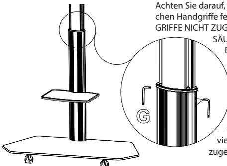
Eine Person hält die innere Säule fest, während die zweite Person die Handgriffe löst. Nun kann die innere Säule weiter raus oder rein geschoben werden. Ist die gewünschte Höhe erreicht, werden erst die Handgriffe festgestellt und anschließend alle vier gelösten Schrauben wieder zugezogen.
