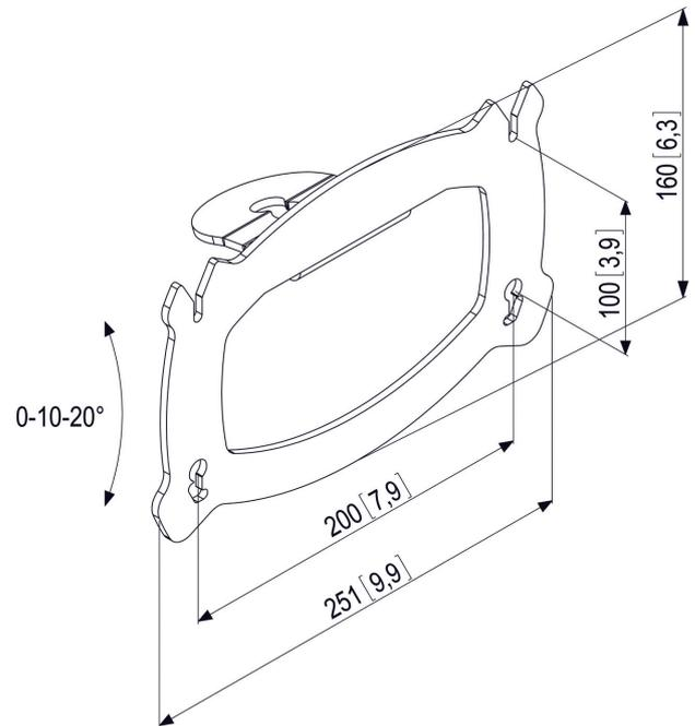
Der PFI 3020 ist für kleine bis mittelgroße Bildschirme (VESA 200x100 mm) bis 30 kg geeignet. Dieser Adapter ist mit einer Nivellier- und Neigungsfunktion (in Stufen von 0-10-20°) versehen. Für eine komplette Deckenbefestigungslösung kombinieren Sie diesen Bildschirm-Adapter mit einer der Connect-it Deckenkonsolen (PUC 1010, PUC 1030, PUC 1040) oder einem Traversenadapter (PUC 1050) und einem der Profile/Rohre aus der Connect-it Reihe (PUC 2108, PUC 2115, PUC 2130, PUC 2308, PUC 2315, PUC 2330).
