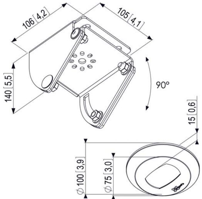
Diese Deckenkonsole ist für flache und schräge Decken (bis 90°) geeignet. Für eine komplette Deckenbefestigungslösung kombinieren Sie diese Deckenkonsole mit einem der Profile/Rohre aus der Connect-it Reihe (PUC 2108, PUC 2115, PUC 2130, PUC 2308, PUC 2315, PUC 2330) und einem Connect-it Adapter (PFI 3010, PFI 3020, PFI 3030, PFI 3040).
