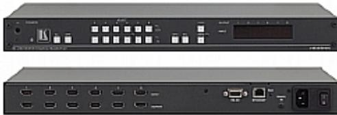
VS-66HN ist ein Hochleistungs-Matrixschalter für HDMI-Signale. Das Gerät taktet die Signale neu, entzerrt sie und kann jeden Eingang an jeden beliebigen oder alle Ausgänge gleichzeitig weiterleiten.
