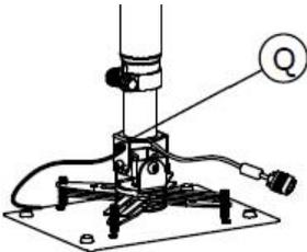
8. ANPASSEN DER STANGENLÄNGE Lösen Sie das Halsstück in der Mitte der Stange und passen Sie sie entsprechend an. Ein Sicherheitsanschlag schränkt die Bewegung ein und verhindert, dass zwei Teile auseinanderfallen.
