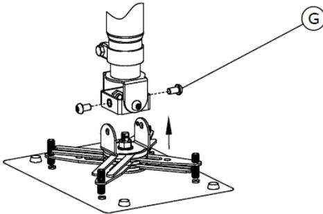
7. ANBRINGEN EINER SICHERHEITSBEFESTIGUNG Es empfiehlt sich, den Projektor am Ständer mithilfe eines zusätzlichen Sicherheitskabels anzubringen, für den Fall, dass die Halterung falsch eingesetzt wurde und herunter fällt.
