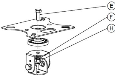
3. **ANBRINGEN DER DECKENPLATTENEINHEIT AM STÄNDER**
