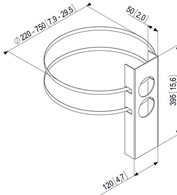
Die PFA 9031 ist speziell für die Befestigung von LCD/Plasma-Displays auf Säulen gedacht.
