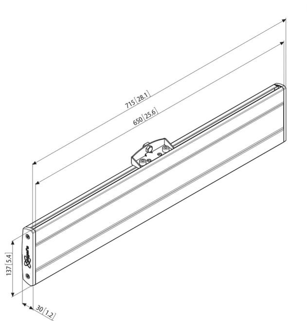
PFB 3407 ist für mittelgroße bis große Displays bis 80 kg Gewicht und einem max. horizontalen Passbereich von 650 mm geeignet. Kombinieren Sie diese Adapterleiste mit einer Connect-it Deckenkonsolle (PUC 1060 / 1070 / 1080/ 1090), einem Connect-it Rohr (PUC 2508 / 2515 / 2530) und einem Connect-it Displayadapter (PFS 3303 / 3304 / 3305 / 3306 / 3308 / 3311) zu einer Komplettlösung für die Deckenbefestigung.
