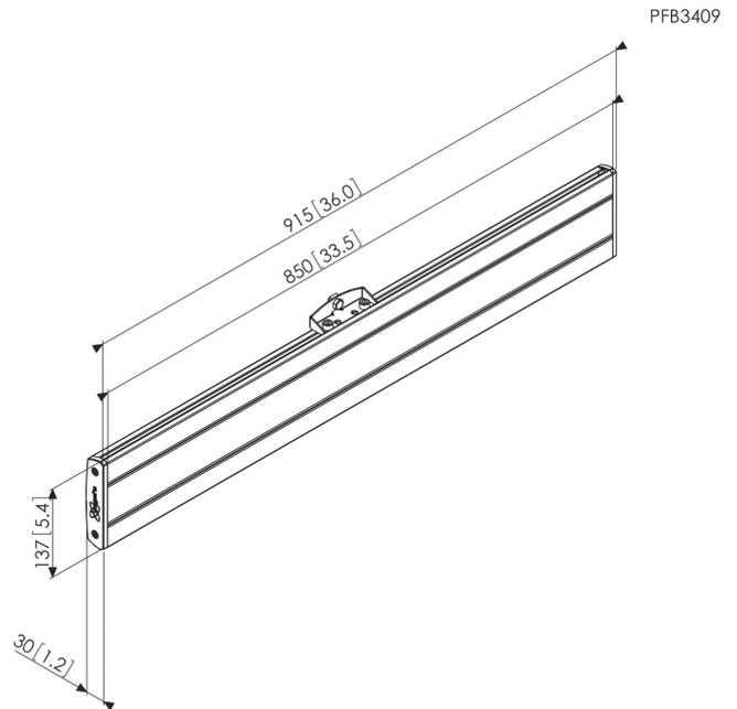
PFB 3409 ist für mittelgroße bis große Displays bis 80 kg Gewicht und einem max. horizontalen Passbereich von 850 mm geeignet. Kombinieren Sie diese Adapterleiste mit einer Connect-it Deckenkonsolle (PUC 1060 / 1070 / 1080/ 1090), einem Connect-it Rohr (PUC 2508 / 2515 / 2530) und einem Connect-it Displayadapter (PFS 3303 / 3304 / 3305 / 3306 / 3308 / 3311) zu einer Komplettlösung für die Deckenbefestigung.
