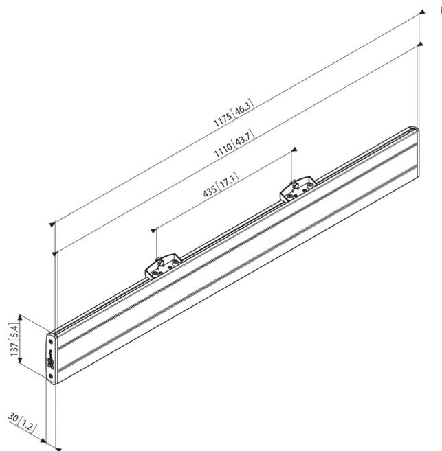
PFB 3411 ist für mittelgroße bis große Displays bis 80 kg Gewicht und einem max. horizontalen Passbereich von 1110 mm geeignet. Kombinieren Sie diese Adapterleiste mit einer Connect-it Deckenkonsolle (PUC 1060 / 1070 / 1080/ 1090), einem Connect-it Rohr (PUC 2508 / 2515 / 2530) und einem Connect-it Displayadapter (PFS 3303 / 3304 / 3305 / 3306 / 3308 / 3311) zu einer Komplettlösung für die Deckenbefestigung.
