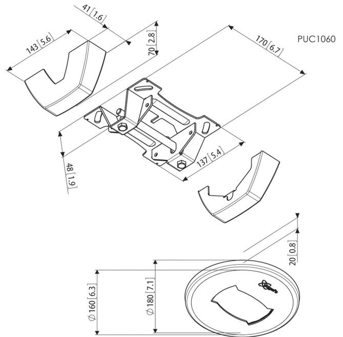
Diese Deckenkonsolle ist für flache Decken geeignet. Kombinieren Sie diese Deckenkonsolle mit einem Rohr aus der Serie Connect-it (PUC 2508, PUC 2515 oder PUC 2530), einer Connect-it Adapterleiste (PFB 3405, PFB 3407, PFB 3409 oder PFB 3411) und einem Connect-it Displayadapter (PFS 3303, PFS 3304, PFS 3305, PFS 3306, PFS 3308 oder PFS 3311) zu einer Komplettlösung für die Deckenbefestigung.
